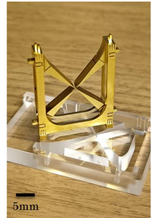
図 1：金メッキを施した 3D プリント・イオン・トラップと、それを機械加工したガラス基板
